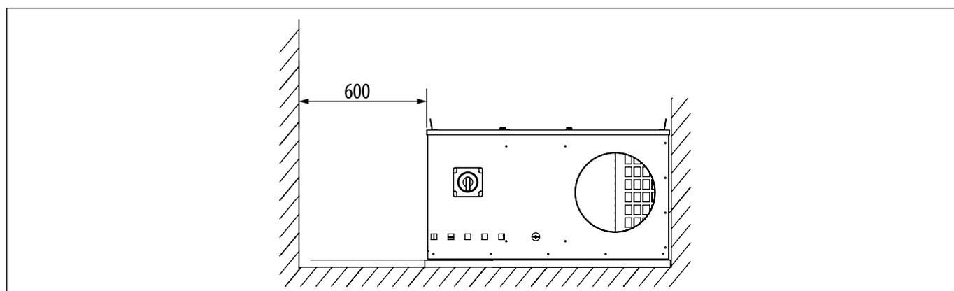
**Important : S'assurer que les ouvertures carrées de refroidissement moteur (situées au-dessous de la commande du sectionneur) ne soient pas obstruées.**
