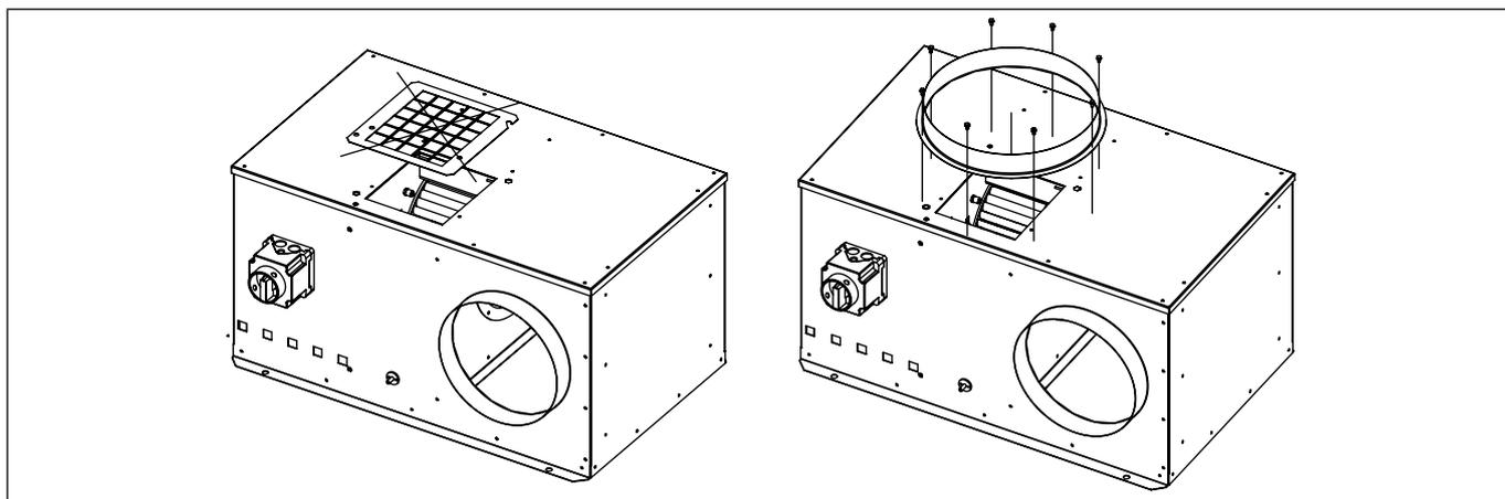
Pour le montage d'un piquage de raccordement circulaire au refoulement, démonter complètement la grille de protection avec une clef de 13.
