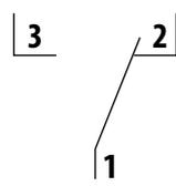
Bascule pour une mesure de pression  $\Delta P >$  au seuil  $\Delta P_0$  de réglage du dépressostat
