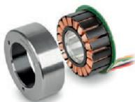
Le moteur EC se compose principalement d'un aimant permanent qui génère, avec le courant dans l'enroulement du stator, un couple de force sur le rotor sans générer aucune dissipation d'énergie : par conséquent, ce fait augmente le rendement du moteur.
