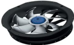
Les ventilateurs axiaux, situés dans la section de condensation de la machine, sont de type hélicoïdal, équilibrés statiquement et dynamiquement et protégés électriquement par des fusibles et mécaniquement par des grilles.
