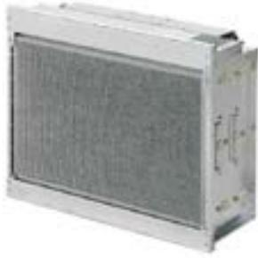
Le rendement des filtres électrostatiques installés sur les unités roof-top est équivalent à la classification H10 pour les filtres traditionnels, comparable à la catégorie de « filtre absolu ». Leur efficacité vaut également pour les fumées, poussières fines, particules PM10, PM2.5, PM1, bactéries, microbes et virus, grâce à un pouvoir filtrant de 0,3 - 0,4 µm.
