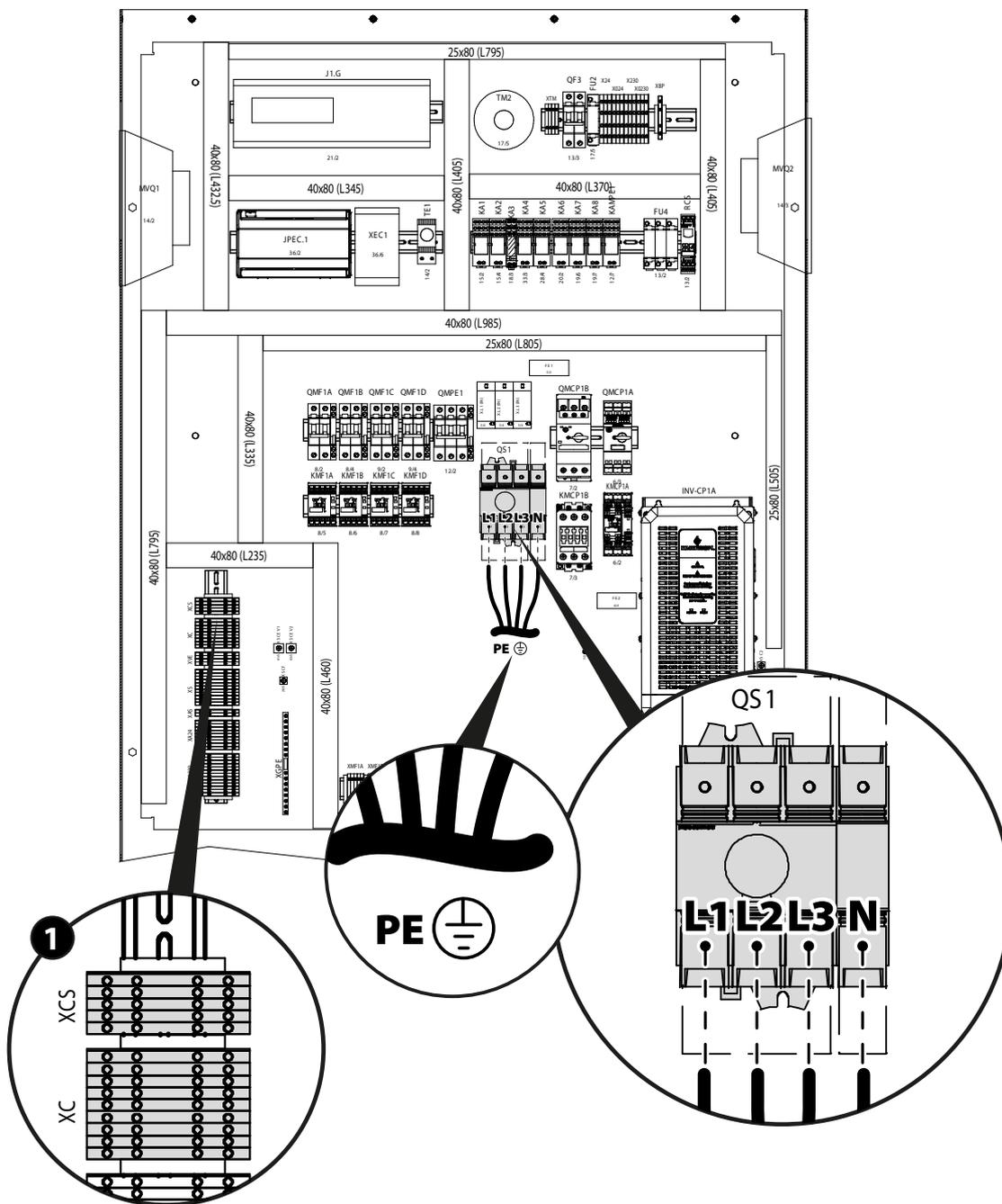
1 Position boîte à bornes auxiliaire sur tableau électrique
