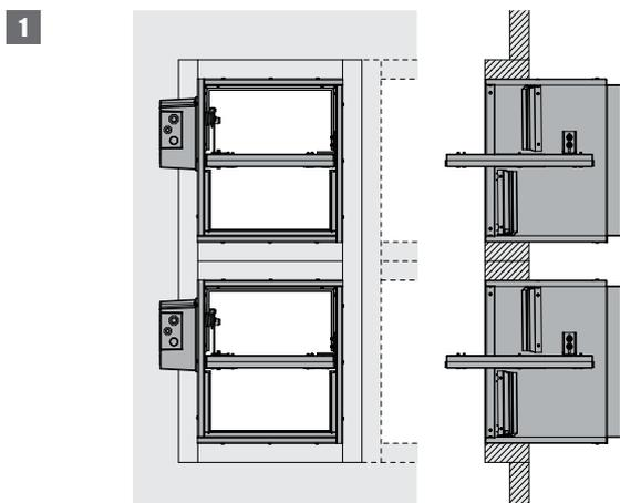
1. Les volets de désenfumage peuvent être montés à distance minimale l'un au dessus ou à côté de l'autre, s'ils sont montés dans des manchon séparés en matériau du conduit avec la résistance au feu souhaitée. Il est conseillé de ne pas dépasser une configuration de 2 x 4 (H x L).
