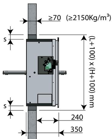
1. Faites une baie aux dimensions  $(L+20) \times (H+20)$  mm jusqu'à  $(L+100) \times (H+100)$  mm.
