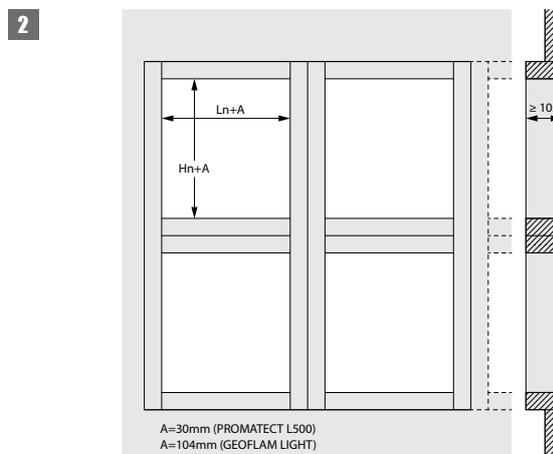
2. Si plusieurs volets de désenfumage sont montés à distance minimale, les points d'appui et de renforcement doivent être ajustés proportionnellement au poids accru. Le montage du conduit doit être conforme au rapport de classement du fabricant du conduit.
