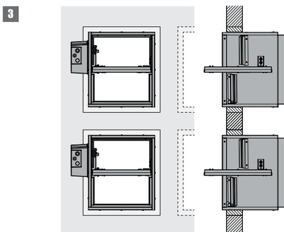
3. Lors du montage de plus que 2 volets de désenfumage dans un conduit en béton, il est nécessaire de prévoir un renforcement continu dans les colonnes verticaux d'au moins 4 x Ø 8 mm.
