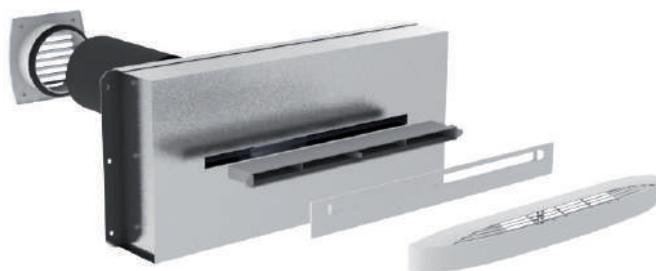
Le silencieux **SRT+ 30/57** (associé aux entrées d'air autoréglables 22 et 30 m<sup>3</sup>/h) est équipé, dans son fût de raccordement, d'une mousse acoustique longueur 135 mm épaisseur 20 mm.
