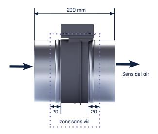
Les gaines s'emboîtent sur les manchettes de connexion métalliques sans porter sur la partie en matière plastique. L'étanchéité est assurée par mastic, ruban adhésif ou colliers en fonction du type de conduit.
