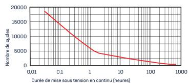
La courbe ci-contre indique le nombre de cycles (ouverture/ fermeture) maximal en fonction de la durée de mise sous tension en continu du registre motorisé.
