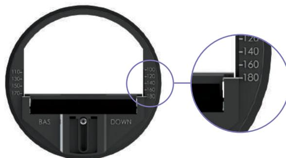
**Exemple de réglage à 180 m³/h :**
