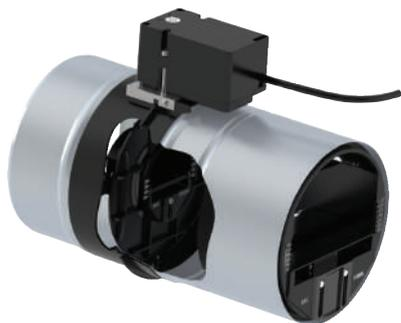
Le débit mini est donné par le régulateur de débit dans le volet en position fermé (hors tension). Le débit maxi est donné par le régulateur de débit en amont du registre lorsque le volet est ouvert (sous tension).
