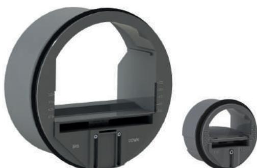
Le régulateur de débits réglables RDR peut être réglé sur chantier au débit souhaité pour assurer un débit déterminé dans une plage de pression comprise entre 50 et 250 Pascals. Les graduations sur les côtés de l'ouverture indiquent les réglages.
