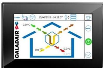
**EDT2** : Commande d'ambiance USER tactile et déportée, décalage de consigne de température, relance de 120 min, ou affichage d'informations (régime et état de ventilation, mode de fonctionnement, forçages externes, consigne de température, et présence d'alarmes)
