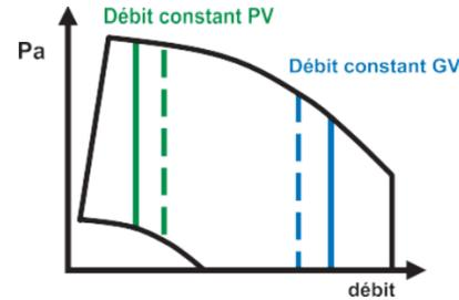
**DIVA** : modulation proportionnelle entre 2 vitesses de rotations pour chaque ventilateur via sonde CO2.
