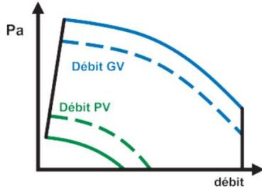
**MAC 2** : 2 débits constants réglables par ventilateur. Capteur de pression intégré à l'appareil.
